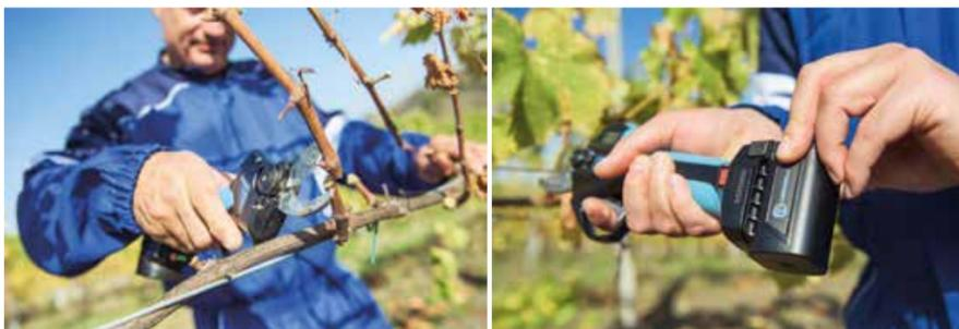
e agrumicoltura e delle piante ornamentali. L'elemento fondamentale è la batteria plug-in, incorporata alla base dell'attrezzo, che garantisce la potenza necessaria per un'ottima performance di taglio e durata. Il peso della batteria, seppur estremamente contenuto, può però incidere sull'affaticamento del potatore, soprattutto
