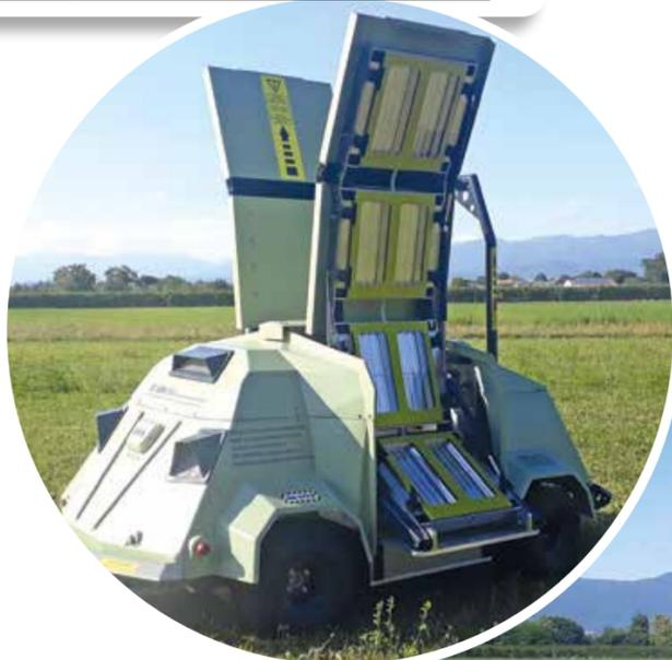
**Presentato il robot Icaro X4 predisposto per il trattamento in totale autonomia dei vigneti con i raggi ultravioletti, con lo scopo di contenere le principali malattie (peronospora, oidio e botrite) attraverso l'azione "killer" di questi raggi**
