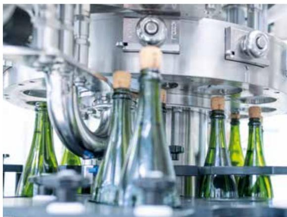
(versione RF) fino a 27 teste. Quasar dispone di un sistema di aspirazione lavabile che riduce al minimo la presenza di polvere generata dai tappi di sughero aspirandola direttamente dai tappi sia sul pick and place che nella scatola porta compressori, prolungando il ciclo di vita dei componenti. È completamente lavabile e presenta un sistema di evacuazione aria e iniezione gas nel collo delle bottiglie dotato di un sistema di lavaggio del circuito dal tappatore fino alla pompa del
