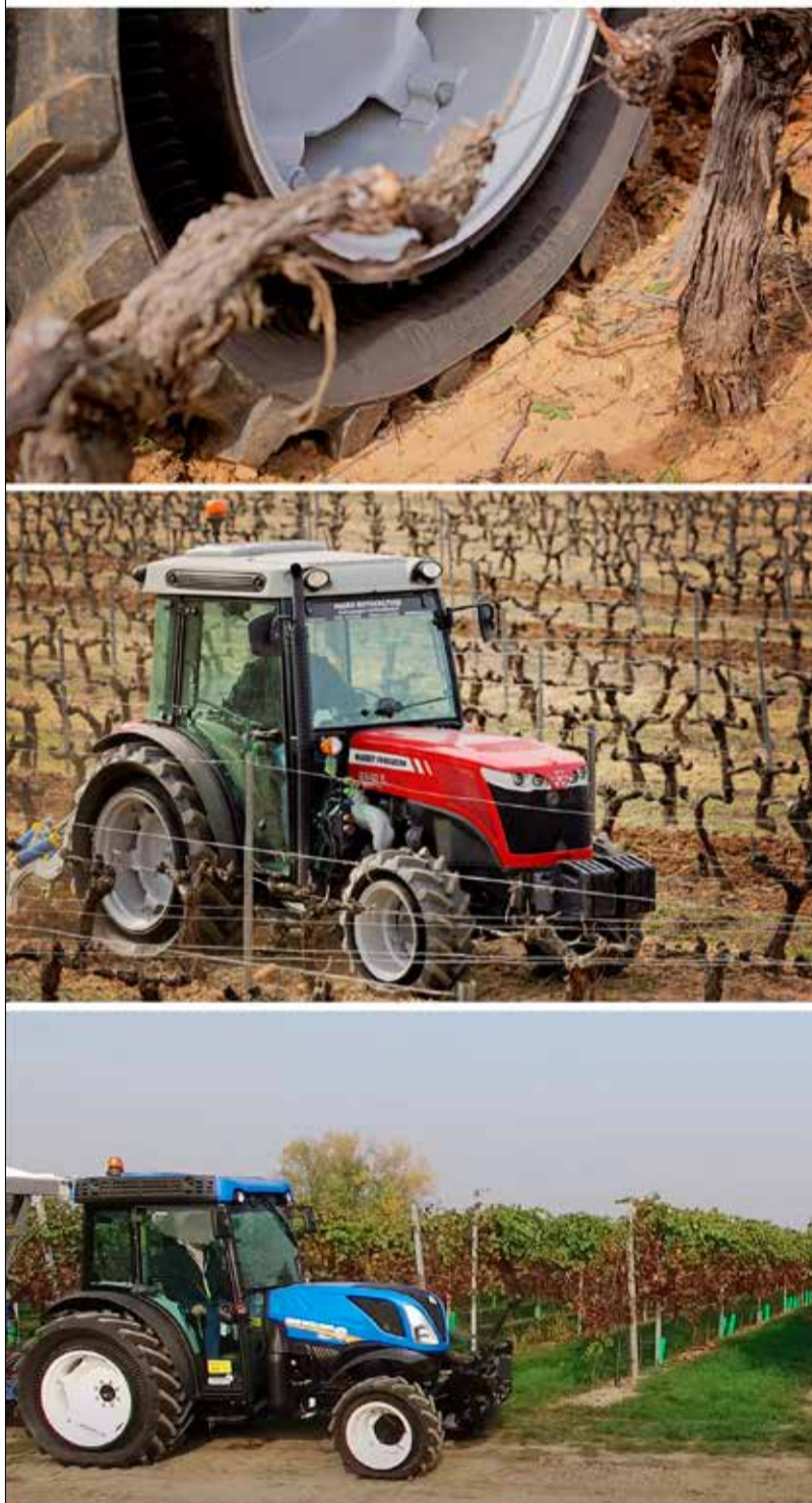
Fig. 6 Proprio per limitare il compattamento del soprassuolo nel vigneto, la gamma PneuTrac è stata estesa a misure specifiche per i trattori a carreggiata stretta.
