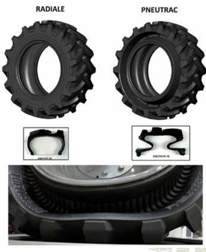
Fig. 5 Rispetto ad uno pneumatico radiale di pari misura, già a bassi carichi il profilo a omega del PneuTrac (sopra) comporta un incremento della superficie di contatto, specie in lunghezza (sotto).
