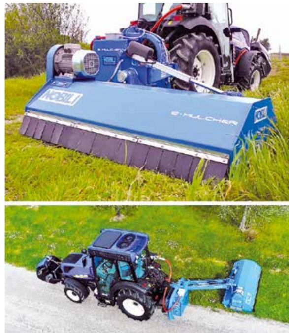
**FIGURA 5.** Oltre al rotore principale, sulla trinciatura E-Mulcher di Nobili sono gestite elettricamente anche le movimentazioni della testata trinciante.
