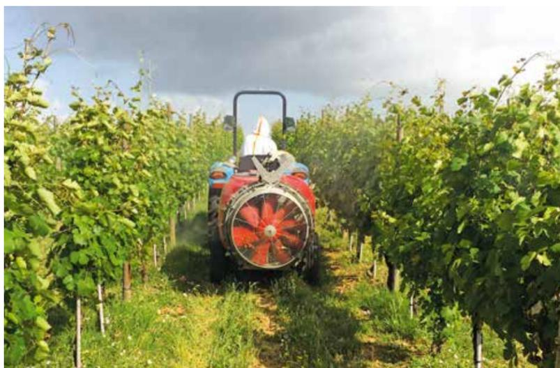
**FIGURA 1.** Esempio di trattamento fitosanitario in vigneto condotto con un trattore privo di cabina
