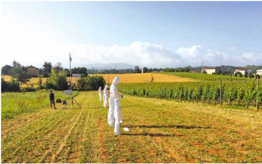
**FIGURA 3.** Manichini disposti ad 8 metri di distanza dal vigneto trattato per simulare la presenza di astanti
