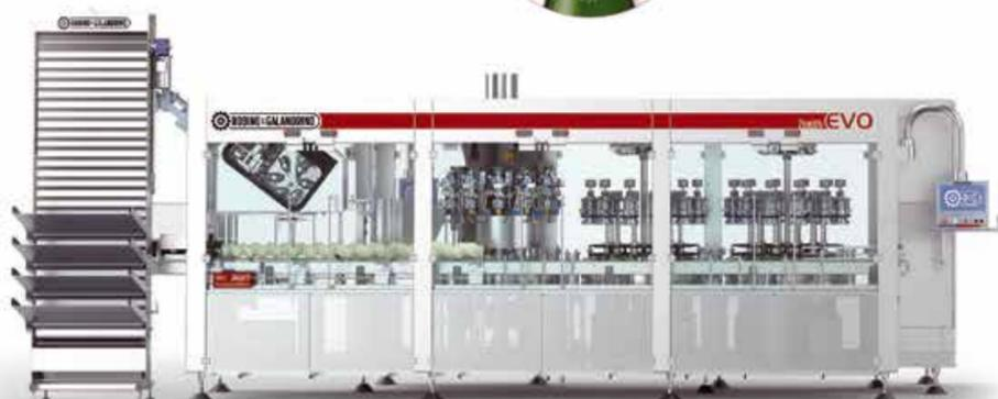
Alimentazione, distribuzione e applicazione di capsuloni per spumanti con doppio centraggio: orientamento della bottiglia (marchio in rilievo su vetro, serigrafia, sleeve e giunzione stampo vetro) e del capsulone, entrambi con telecamere gestite da sistema di visione SNIPER.
