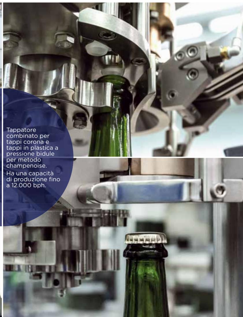
Tappare combinato per tappi corona e tappi in plastica a pressione bidule per metodo champenoise. Ha una capacità di produzione fino a 12.000 bph.
