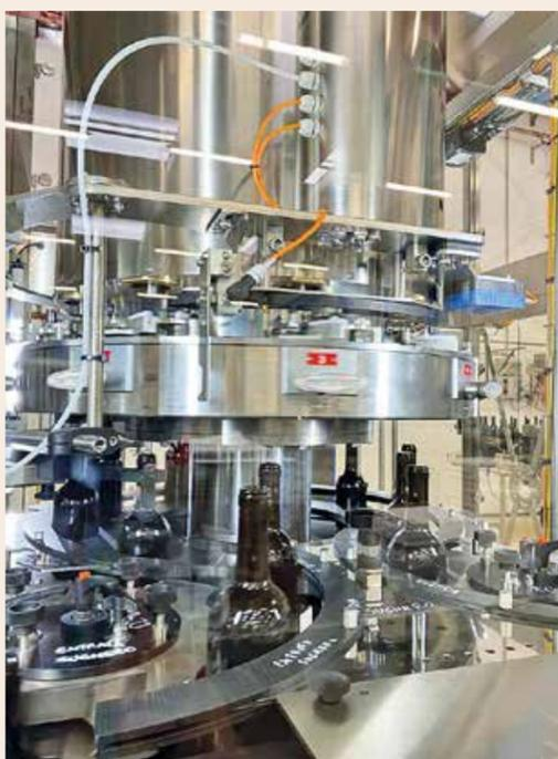
ne da dicembre, e una più piccola installata a gennaio di quest'anno. Si tratta di monoblocchi modulari automatici con postazioni di sciacquatura, riempimento e tappatura, dotati di PLC per la gestione elettronica di tutte le fasi del processo. La linea più grande, che opera a velocità da 9.000 a 12.000 bottiglie l'ora (a seconda dei formati), è adatta a vini fermi, frizzanti e spumanti. Gestisce bottiglie che vanno dai 250 ml a 1,5 litri, con diametri da 55 a 105 mm e altezze
