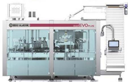
Gabbiettatrice con orientamento della bottiglia (marchio in rilievo su vetro o giunzione stampo) per l'applicazione della gabbietta con posizione programmabile dell'occhiello di apertura (sistema di visione SNIPER).
