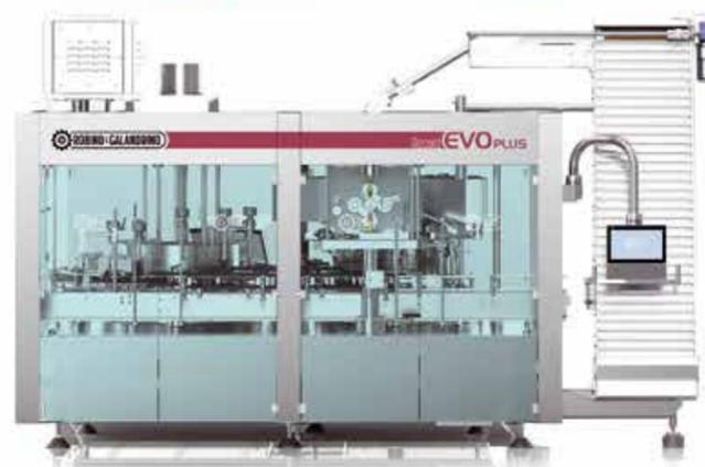
Gabbiettrice con orientamento della bottiglia (marchio in rilievo su vetro o giunzione stampo) per l'applicazione della gabbietta con posizione programmabile dell'occhiello di apertura (sistema di visione SNIPER).
