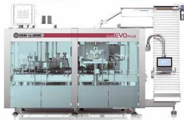
Gabbiettatrice con orientamento della bottiglia (marchio in rilievo su vetro o giunzione stampo) per l'applicazione della gabbietta con posizione programmabile dell'occhiello di apertura (sistema di visione SNIPER).
