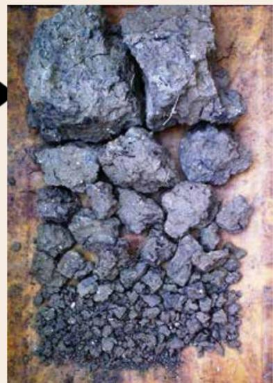
Valutazione della struttura secondo il metodo VSA. Si tratta di un suolo con pessima struttura e scarsa porosità
