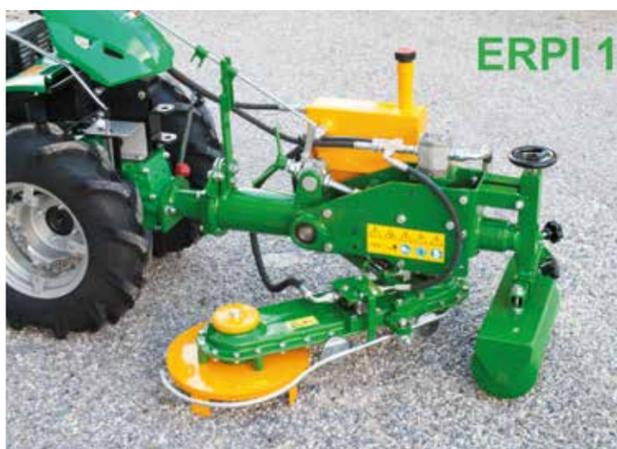
un erpice meccanico con trasmissione a catena, l'altezza di lavoro si regola tramite rullo d'appoggio o ruote su richiesta. La seconda è la Decespugliatrice DT300-DT500, utilizzata per la pulizia di vigneti, filari di
