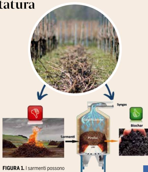
**FIGURA 1.** I sarmenti possono essere avviati alla gassificazione tramite pirolisi, per produrre energia elettrica e termica, ma anche per ottenere il biochar, un ottimo ammendante per terreni
