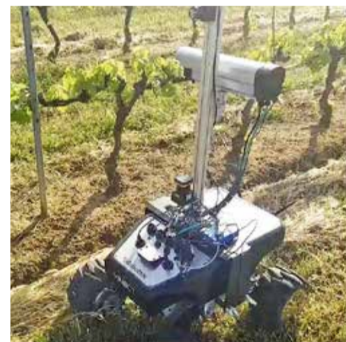
FIG. 7. Il Vinbot, progettato in Portogallo, rileva immagini per il monitoraggio continuo dello stato di salute e dello sviluppo vegetativo delle varie zone del vigneto
