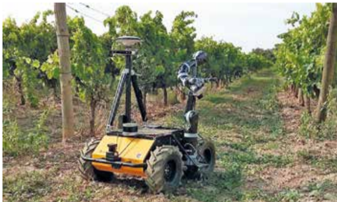
FIG. 10. Il Grape di AirLab è dotato di un braccio meccanico, tramite il quale nell'occasione sono stati collocati sulle viti dei dispenser a feromoni per la lotta integrata ai parassiti
