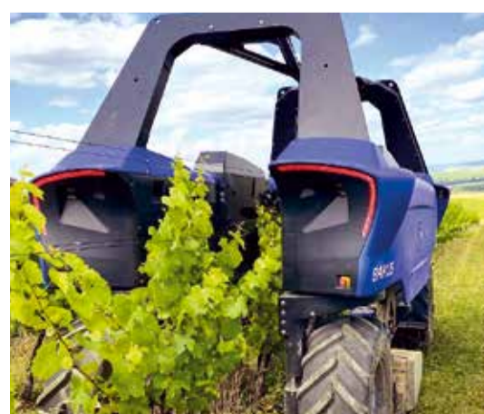
FIG. 8. Tra le diverse lavorazioni che può svolgere, il robot Bakus di Vitibot effettua anche il diserbo meccanico sottofila
