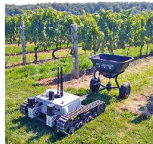
FIG. 5. Il piccolo robot RoamIO della canadese Korechi Innovations può effettuare semine e concimazioni granulari
