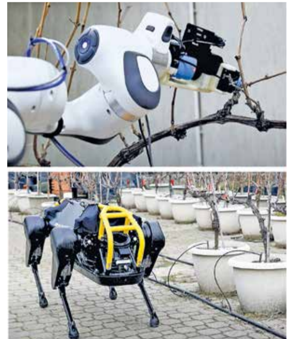
FIG. 12. Il progetto Prinbot prevede un braccio meccanico "istruito" con tecniche di "deep learning" per la potatura secca nel vigneto (sopra) montato sul robot quadrupede HyQReal, che sarà in grado di muoversi anche in vigneti a forte pendenza (sotto)
