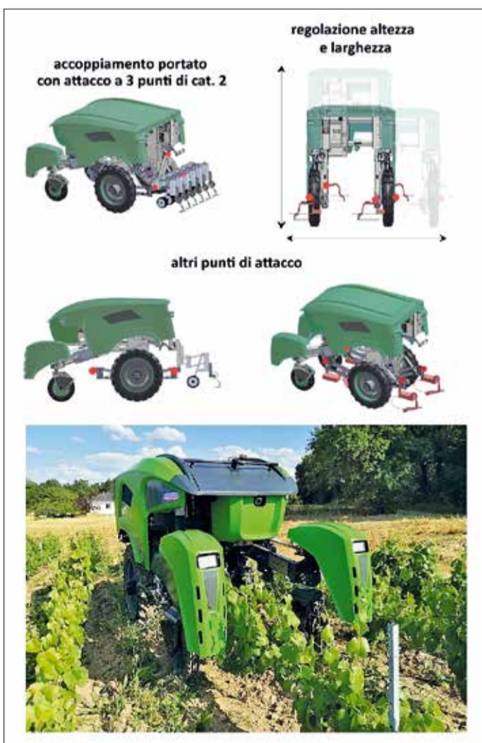
FIG. 3. Il Trektor della francese Sitia è dotato di sollevatore posteriore ed è regolabile in larghezza e altezza
