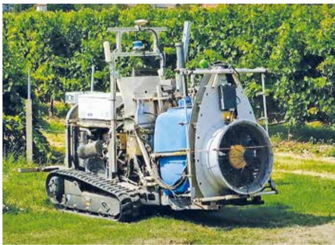
FIG. 11. Il Rovitis comprende la funzione Slam (Simultaneous localization and mapping) per l'autonoma costruzione di una mappa in ambiente sconosciuto e di apprendimento delle traiettorie da percorrere, grazie a un Lidar
