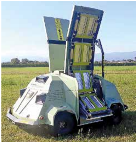
FIG. 9. Icaro X4 dell'italiana Free Green Nature effettua trattamenti antibatterici e antimicotici sulla vite, grazie all'esposizione della vegetazione ai raggi UV-C
