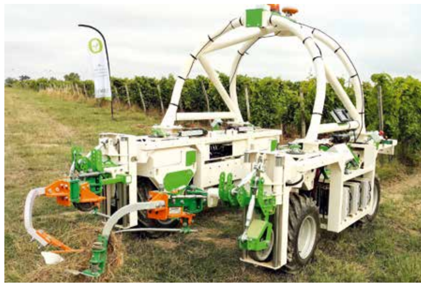
FIG. 4. Il robot Ted della Naio Technologies adotta un sistema di navigazione particolarmente completo, composto da GPS, Lidar, sensori a ultrasuoni e videocamere
