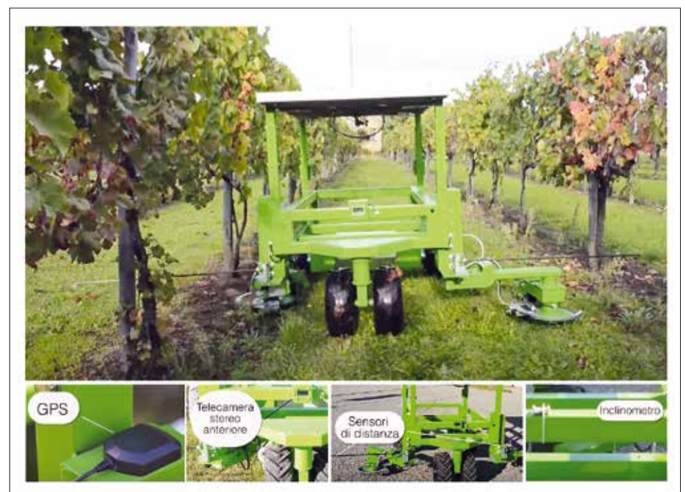
FIG. 1. L'Agrirobot dell'italiana Zucchetti, dedicato allo sfalcio dell'erba nell'interfilare
